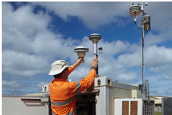
Gambar 7.11 Pemantau debu di Rio Tinto Weipa, Australia
