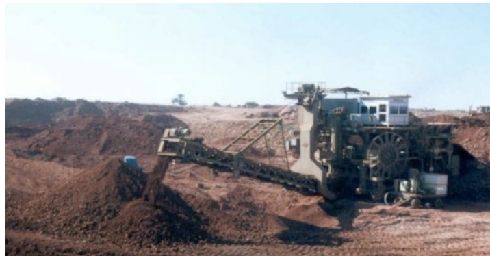
Gambar 7.1 Alat penghancur yang bergerak ( mobile crusher ) di Hindalco Durgmanwadi, India
