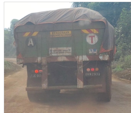
Gambar 5.13 Contoh kendaraan yang tidak dimuat dengan baik dan tidak ditutup secara aman
